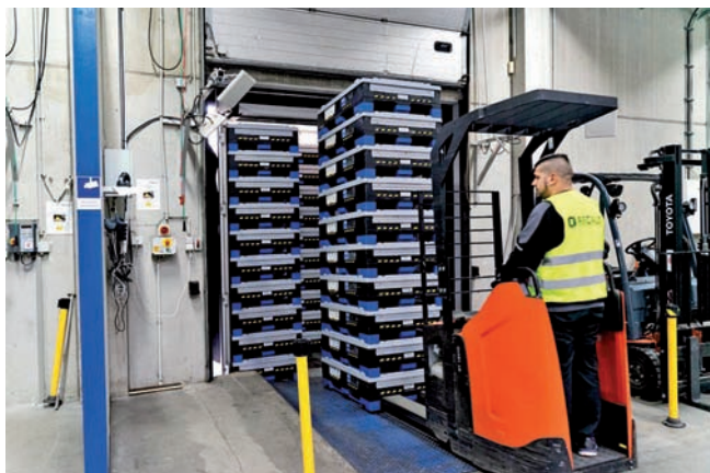
Naskladané RTI sú pri prejazde vysokozdvížneho vozíka bránou načítané ešte pred naložením na kamión.
