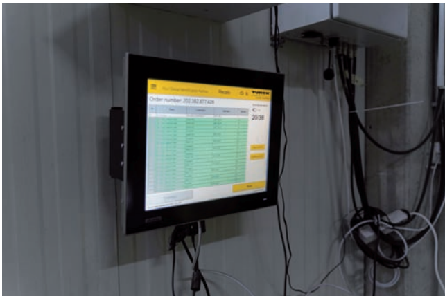
Turck Vilant Client priamo ukazuje, či je vozík naplnený správnymi prepravkami v správnej výške stohovania.
